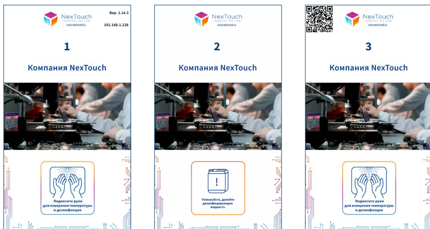
Рис.4. Главный экран Портала обслуживания (слева направо): 1 - в Устройстве есть антисептическая жидкость, 2 - антисептическая жидкость закончилась или отсутствует, 3 - временные сведения в верхней части экрана
